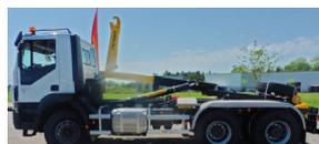
→ Bras **S21** monté sur châssis Xway 6x4 .....
