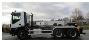
→ Bras **T20 avec PALCOVER** monté sur châssis STRALIS 6x2 .....
