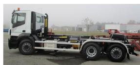
→ Bras **T2 Blackline avec PALCOVER** monté sur châssis STRALIS 6x2 .....
